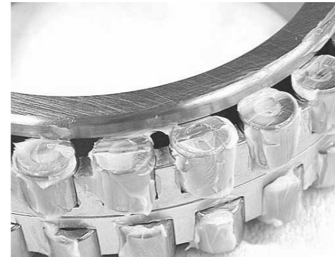
Rys. 1.20 Łożysko walcowe nasmarowane smarem.
